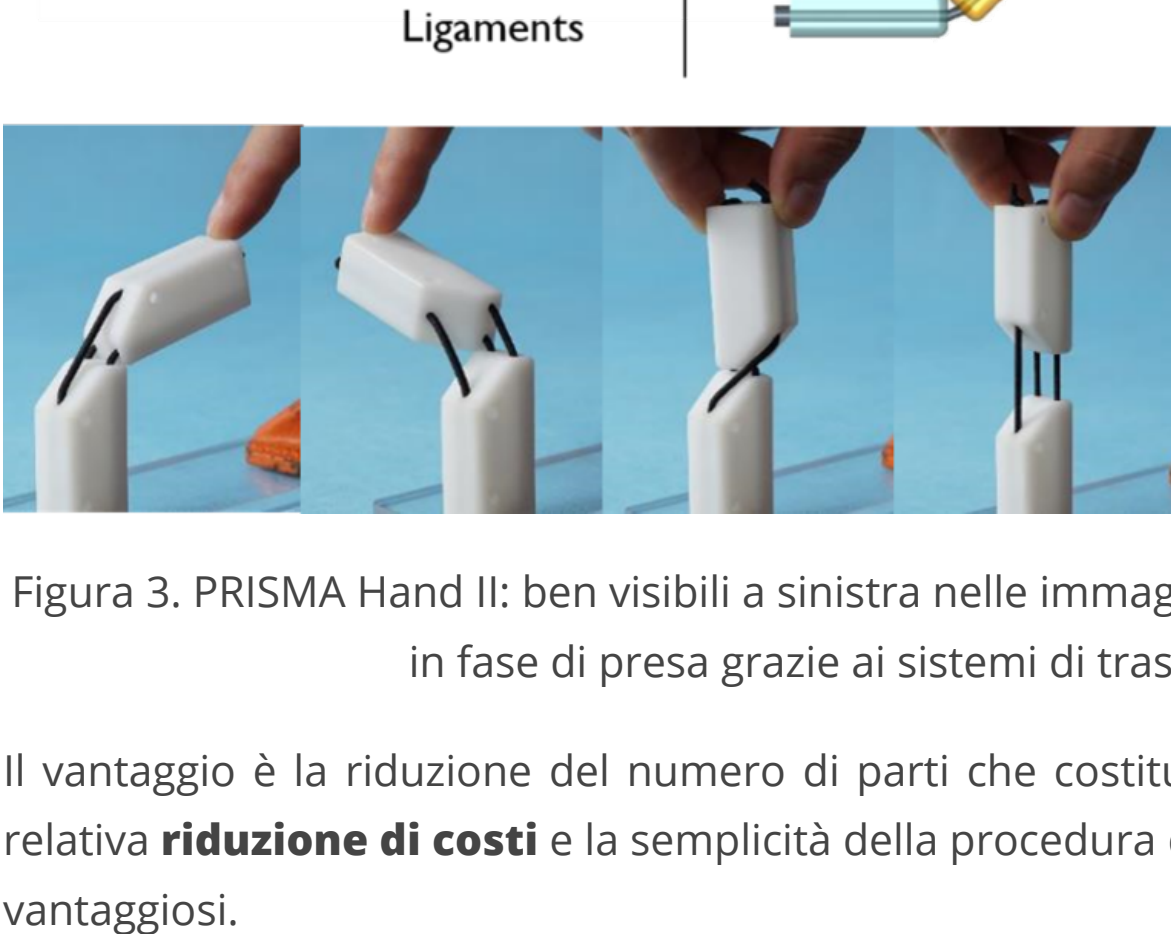
Figura 3. PRISMA Hand II: ben visibili a sinistra nelle immagini in alto e in basso le falangi e i legamenti. A destra, la mano in fase di presa grazie ai sistemi di trasmissione del movimento. Credits: ICAROS
